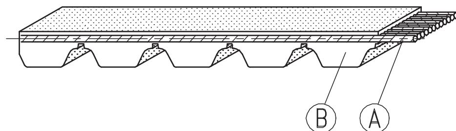
Profil „AT“ je vylepšením metrického typu T. U tohoto profilu dochází k lepšímu záběru řemene a s tím spojenému snížení hlučnosti. Ve srovnání s typem T je možno přenášet o 30 % více energie.
